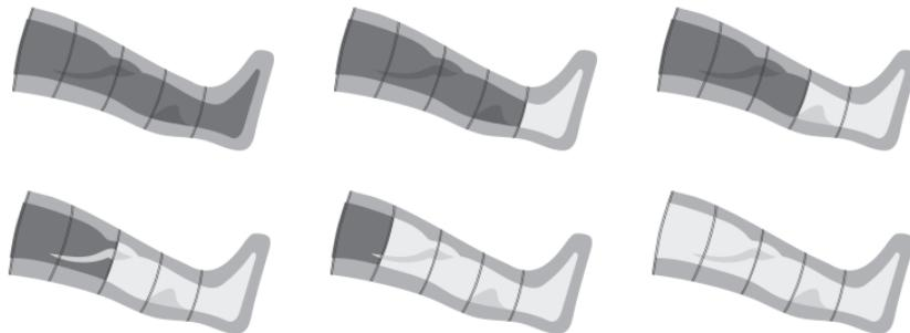
En cada ciclo, la presión se aplica desde la parte inferior de la pierna hacia la parte superior, comenzando por la primera cámara y superponiéndose progresivamente hasta las 5 cámaras.
